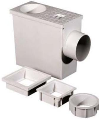
As caixas pluviais são ideais para a recolha de Águas provenientes de algerozes verticais ou de quedas de agua em passeios. A recepção das aguas nas caixas pluviais pode ser efectuada por canos redondos ou rectangulares. As mesmas são providas de uma antecâmara anti-refluxo de cheiros com tampa para fácil inspecção e limpeza.
